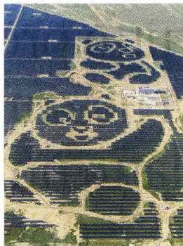
▲ La centrale a forma di panda A Datong, in Cina, una centrale da 100 megawatt. Due varietà di pannelli danno l'effetto dei diversi colori
